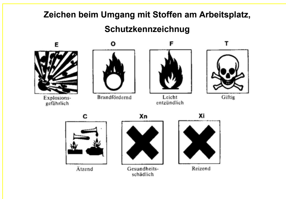
Abb.3.2-15: Schutzkennzeichen für den Umgang mit Gefahrstoffen (Quelle: Remmert u.a.: "Fachbuch für Parkettleger und Bodenleger." S.15)
